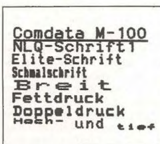
Bild 2. Schriftprobe des M-100 läßt eckige Nadeln erkennen
